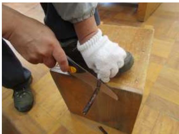
①作る鉛筆の長さを決め、木の枝を足で踏むなどして固定し、クラフト用のこぎりを使って切り始めます。
